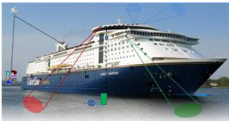
Figur 2. MS Color Fantasy illustrert med dekkens sensorer for lys (blå), havfarge (grønn), overflatetemperatur (rød), kommunikasjon til land og FerryBox systemets omtrentlige plassering i fartøyet.
