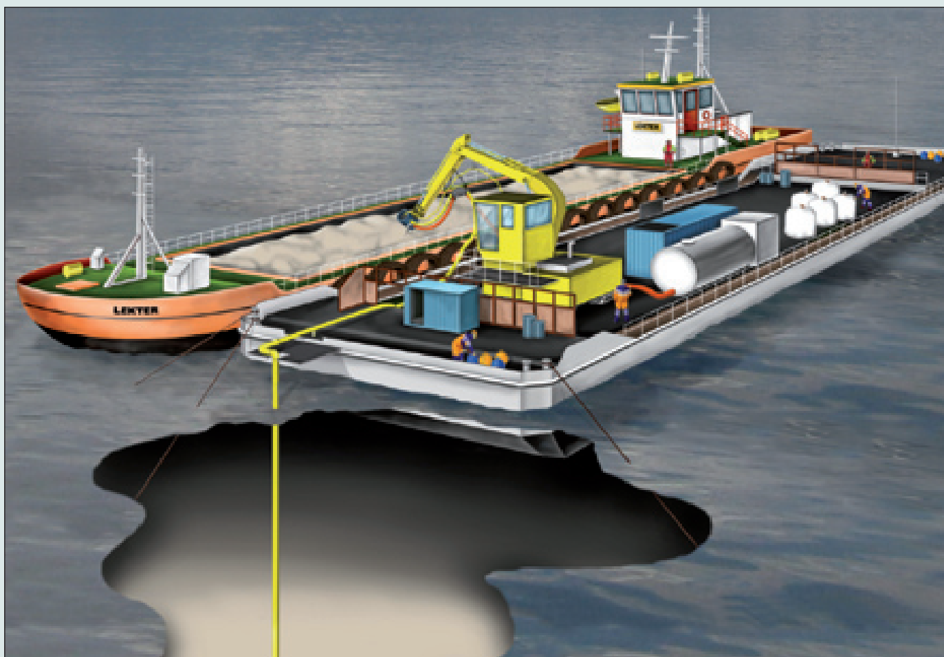
Figuren viser nedføring i deponiet. Mudret masse slipper ikke i overflaten med splitteløker, men pumpes eller graves over i rør hvor så massene faller gjennom røret ned til sjøbunnen.
