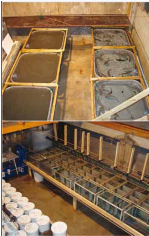
Figur 18. Forsøksoppsett for undersøkelser av opptak av PCB i torsk. Øverst: Torsk på forurenset sediment og torsk i kontrollkar. Nederst: Foringsforsøk. Enkeltindivider av torsk er plassert i separate "celler". Torsken ble matet med PCB-holdige børstemark holdt i sediment fra Oslofjorden, eller i et rent kontrollsediment (i spannene på figuren).
