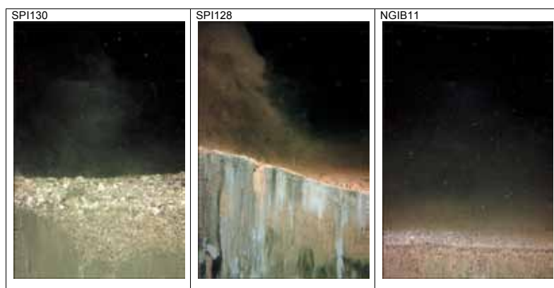
Figur 28. SPI bilder tatt i deponiområdet ved Malmøykalven 12. mai 2009. SPI130: Dekkmasser (sand) på overflaten med bløtere masser lengre ned. SPI128: dekkmasser iblandet noe bløtere masser. NGIB11: Kun dekkmasser.
