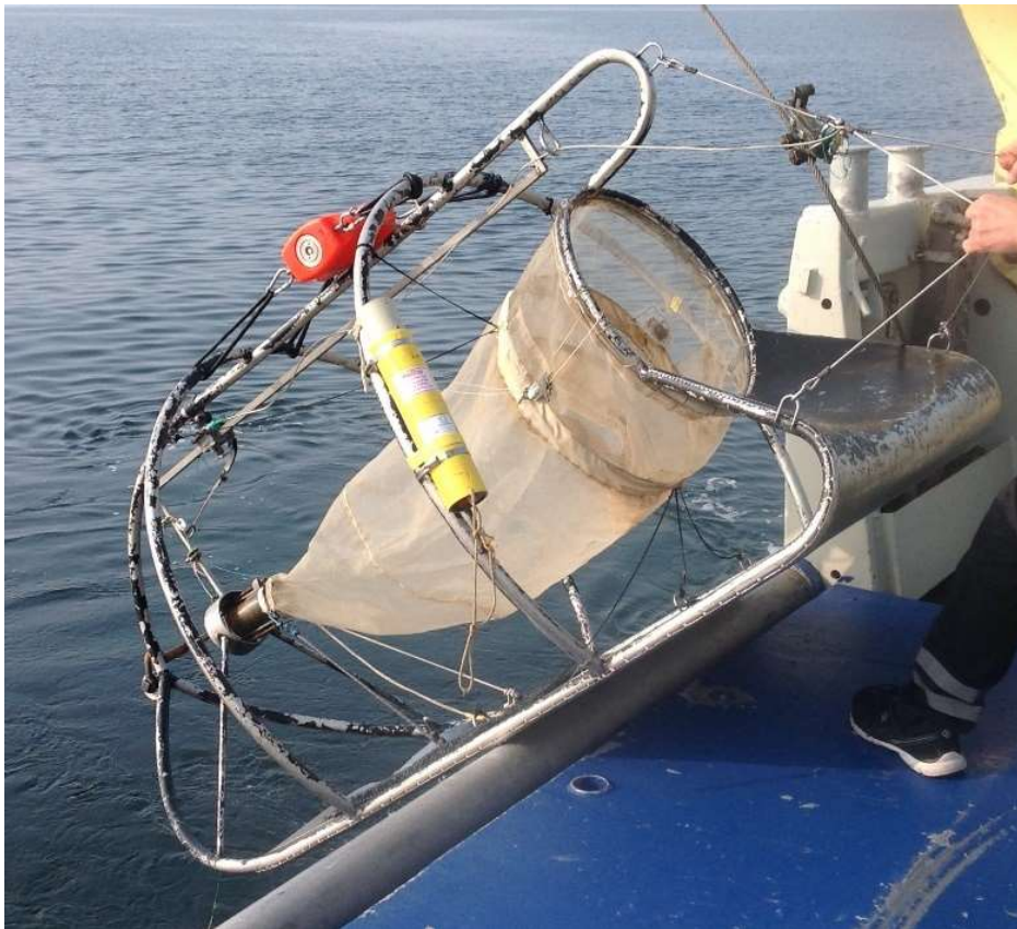
Figur 85. Beyer-slede brukt til innsamling av hyperbentos i utvalgte områder av Indre Oslofjord. (Foto: J. Dolven)
