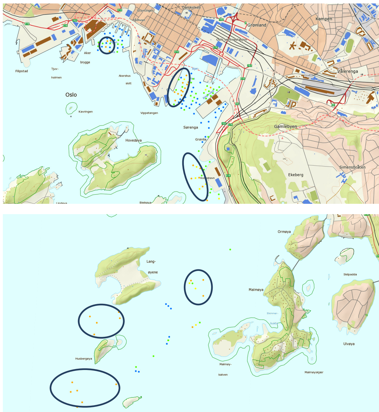
Figur 56. Resultater av klassifisering av miljøtilstand basert på konsentrasjonen av kvikksølv i de øverste 0-10 cm av sedimentet i Havneområdet (øverst) og deponiområdet ved Malmøykalven (nederst) i Indre Oslofjord. Resultater som er tatt med i figurene er data som forelå pr 06.09. 2013 fra alle prøver tatt etter 01.01.2009. Klassifiseringen er gjort i henhold til klassegrensene oppgitt i utkast til TA 3001/2012. Fargekodene brukt for de enkelte tilstandsklasser er vist i Figur 55 . Kilde: Figurer tilsendt fra Plan, utbygging og miljø/Miljø, Oslo Havn KF. I figuren er «hot spots» med høye miljøgiftkonsentrasjoner inntegnet.
