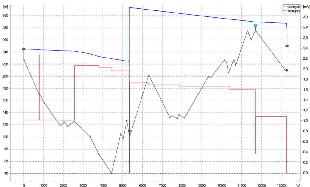
Figur 5.1: Lengdeprofil med kotetrykk (blå linje) og hastighet (rød linje). Profilen starter ved ABV (Holsfjordanlegget/ Kattås) og slutter ved Glitrevannverket (Jerpåsen). Trykkøkningen som skjer ved profil 5400, er ved Furubakken.
