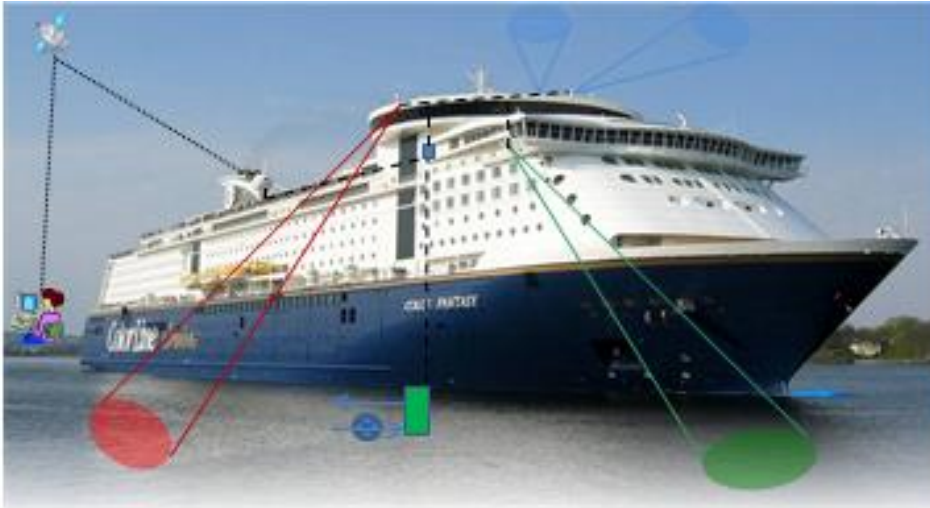
Figur 23. MS Color Fantasy illustrert med deksensorer for lys (blå), havfarge (grønn), overflatetemperatur (rød), kommunikasjon til land og FerryBox systemet omtrentlig plassering i fartøyet.
