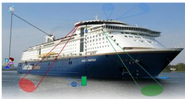
Figur 24. MS Color Fantasy illustrert med dekkensensorer for lys (blå), havfarge (grønn), overflatetemperatur (rød), kommunikasjon til land og FerryBox systemet omtrentlig plassering i fartøyet.
