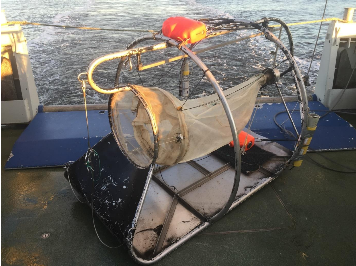
Figur 14. Beyer-slede brukt til innsamling av hyperbentos i utvalgte områder av Indre Oslofjord. (Foto: J. Dolven)
