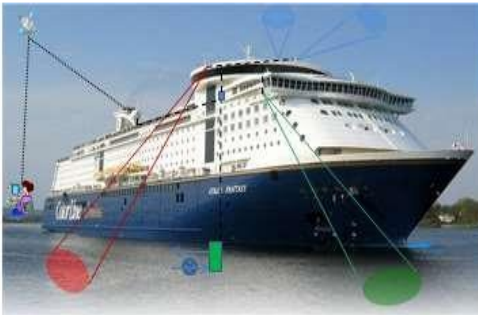
Figur 9. MS Color Fantasy illustrert med dekkens sensorer for lys (blå), havfarge (grønn), overflate-temperatur (rød), kommunikasjon til land og FerryBox systemet omtrentlig plassering i fartøyet.
